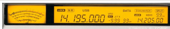
Display de cristal líquido do transceptor Icom, modelo IC775. Três casas decimais após a freqüência fundamental no VFO principal e 2 casas
