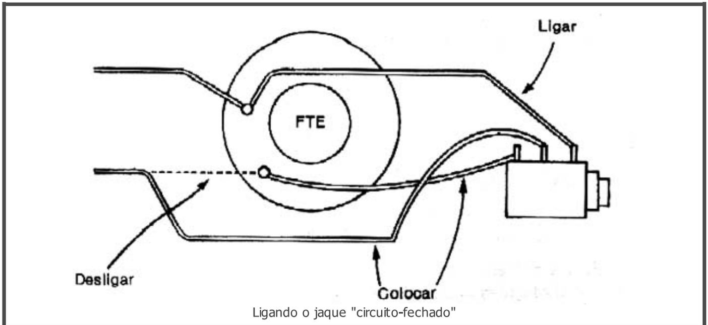
Se o equipamento de som for potente e for ligado um fone deve ser acrescentado um resistor para não sobrecarregar o fone de ouvido. Esse resistor será de  $47\ \Omega$  para aparelhos até 10 W,  $100\ \Omega$  para aparelhos de 10 a 50 W e  $470\ \Omega$  acima de 50 W. Na figura 2 mostramos como fazer sua ligação.
