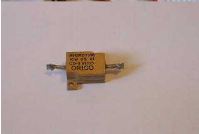
O resistor utilizado foi comercial, mas nada impede de se utilizar um resistor confeccionado com fio de resistência de chuveiro, ou uma montagem de 10 resistores de fio em paralelo de 1.0R 5W.
