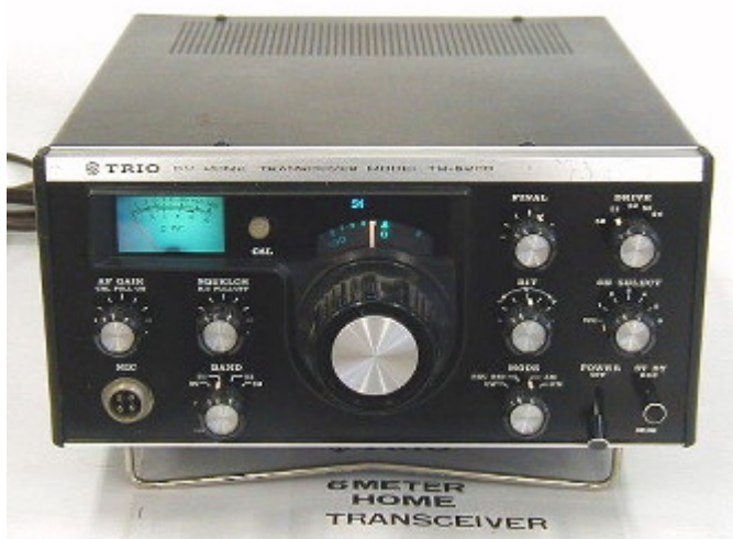
Antigo equipamento valvulado da marca TRIO (atualmente Kenwood) para a banda dos 6 metros
